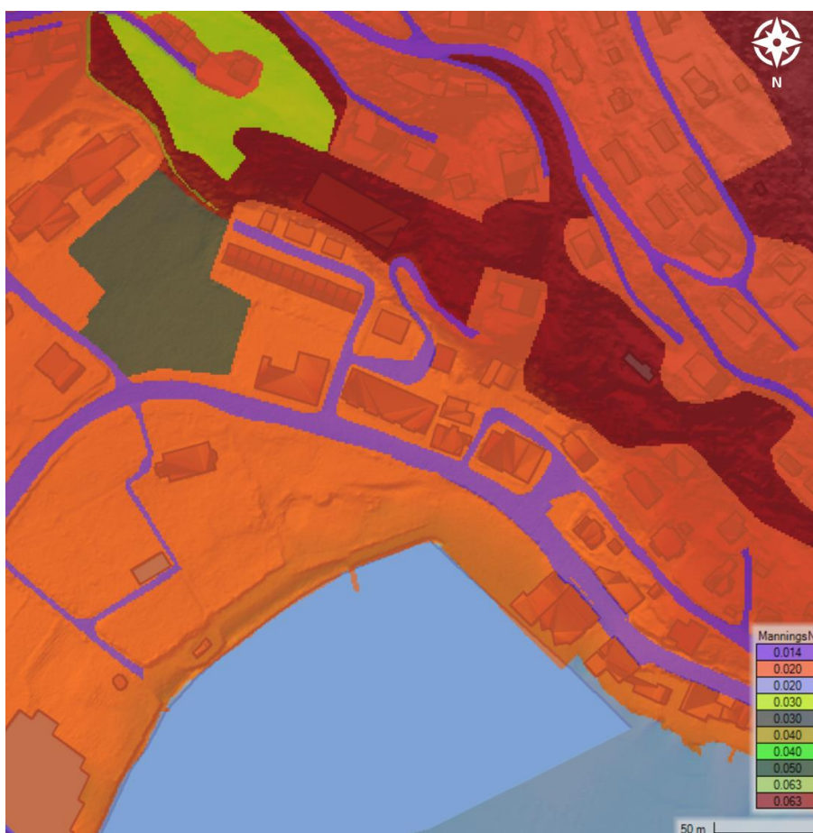
Figur 3-3. Oversikt over fordeling av Mannings tall i den hydrauliske modellen.
