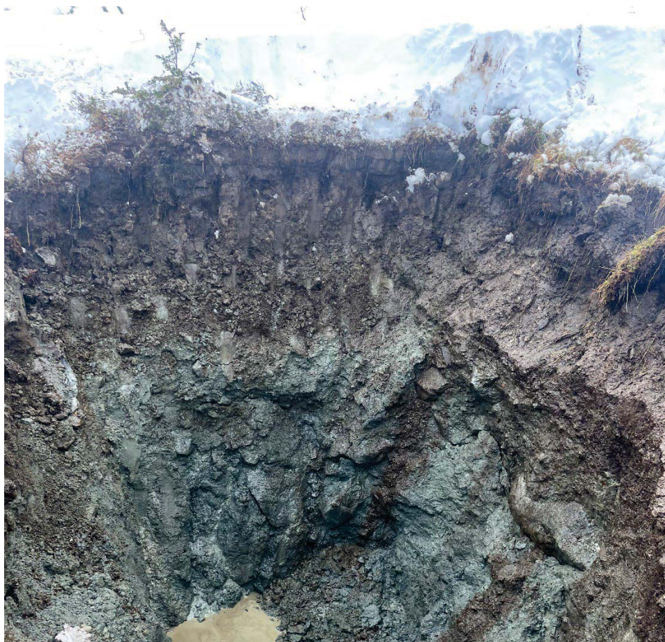
Figur 5-5: Bildet fra prøvegraving i Vasslia. Øverst ligger vegetasjonsdekket (torv), det mørkebrune er humusholdige vekstmasser, nederst ligger morenemasserne.
