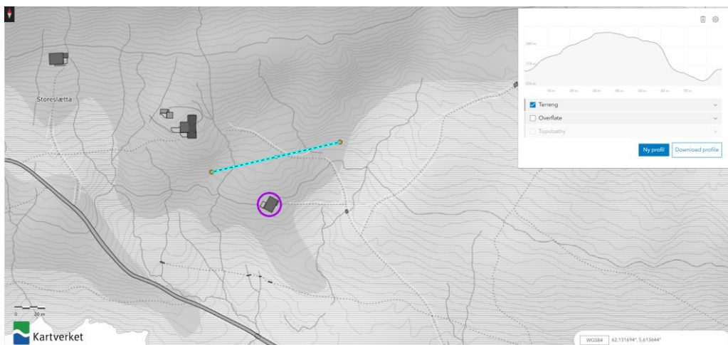
Figur 12 I terrenget på oppsiden av hytten ligger en forhøyning som vil lede skredløp til side for det vurderte arealet.
