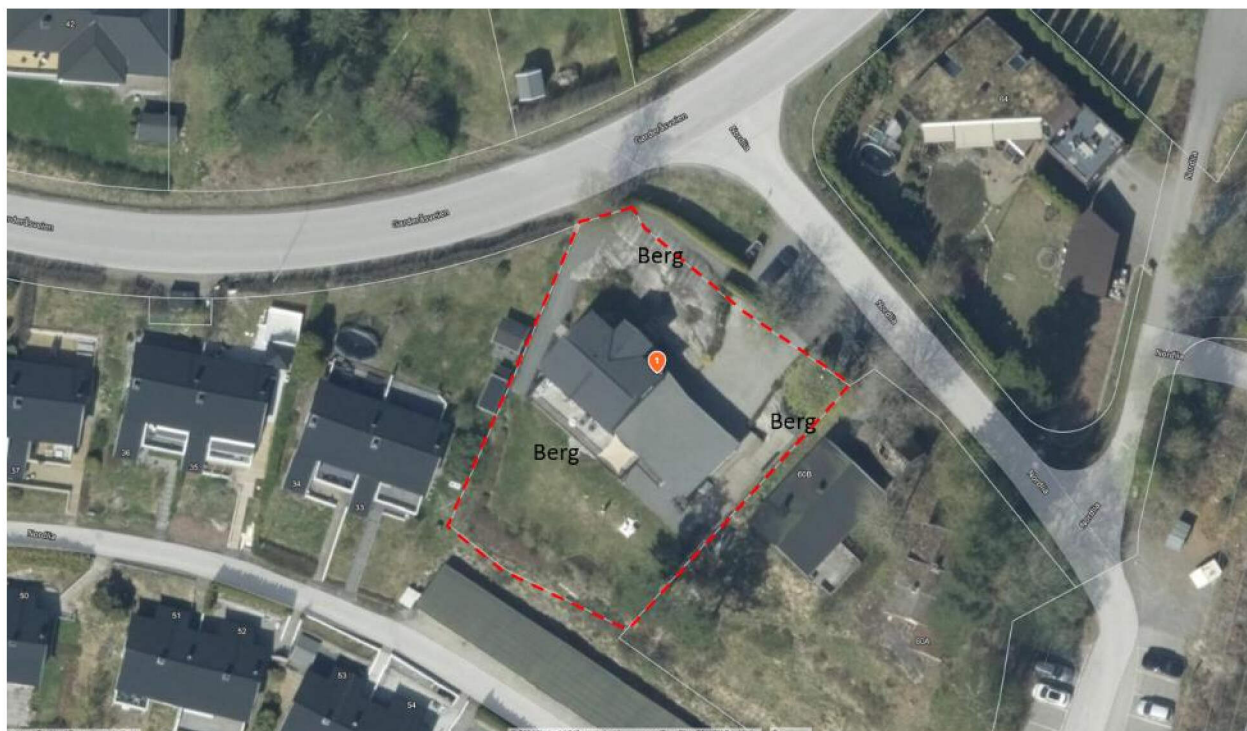
Figur 1 - Oversiktsbilde hentet fra 1881.no. Flyfoto viser at enebolig og garasje ligger på berg.
