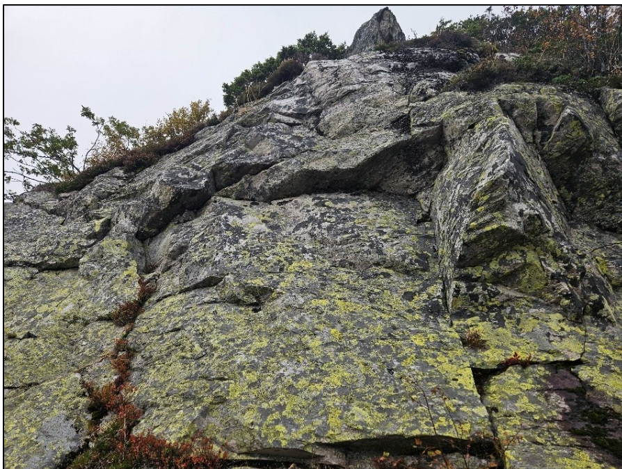
Figur 5: Bergskrent i påvirkningsområdet, ca. 900 moh. Vi observerte verken blokker i nedkant av skrenten som tolkes som steinsprangblokker, eller avløste blokker.
