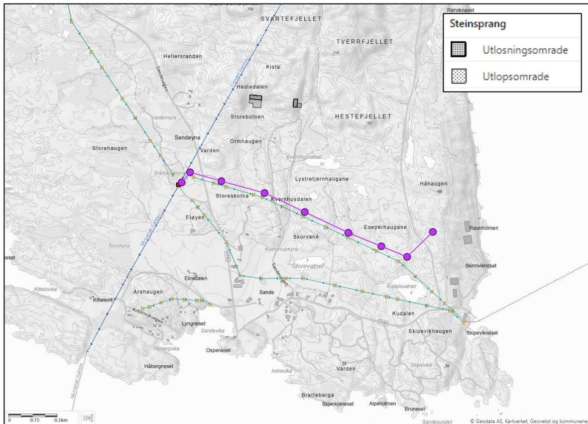
Figur 3-5: Oversiktskart over aktsomhetsområdet for steinsprang nær nettanleggene. Kartgrunnlag fra NVE/Atlas.
