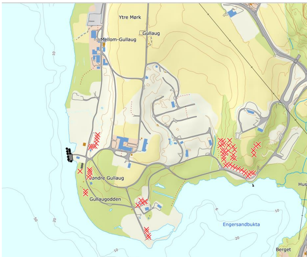
Figur 2.1 Markerte berg i dagen observert under befaring
