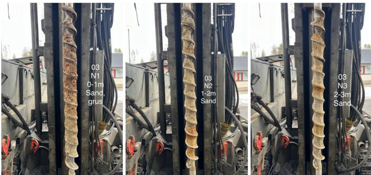
Figur 5: Utførte naverboringer ved 03
