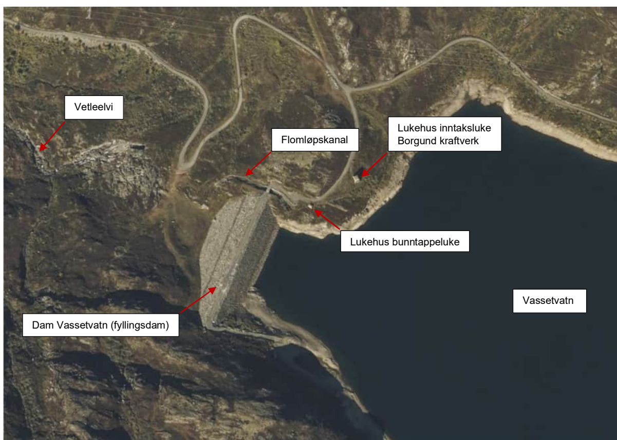
Figur 1 Oversiktskart over eksisterende anlegg.
