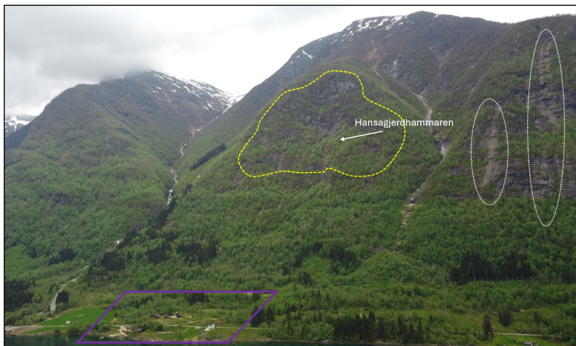
Figur 4-1 Aktuelle utløysingsområder for steinsprang markert i gult. Kartleggingsområde grovt innteikna med lilla. Kvit markering viser spor etter to steinsprang.
