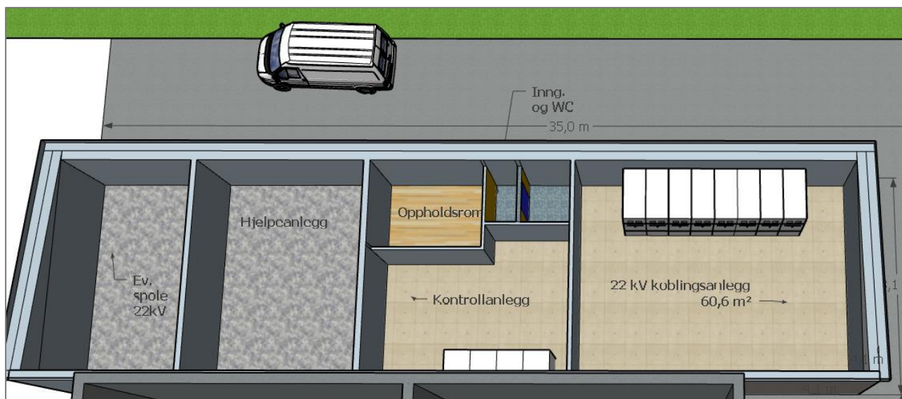
Figur 3-39: Lyses kontroll hus og 22 kV koblingsanlegg innvendig
