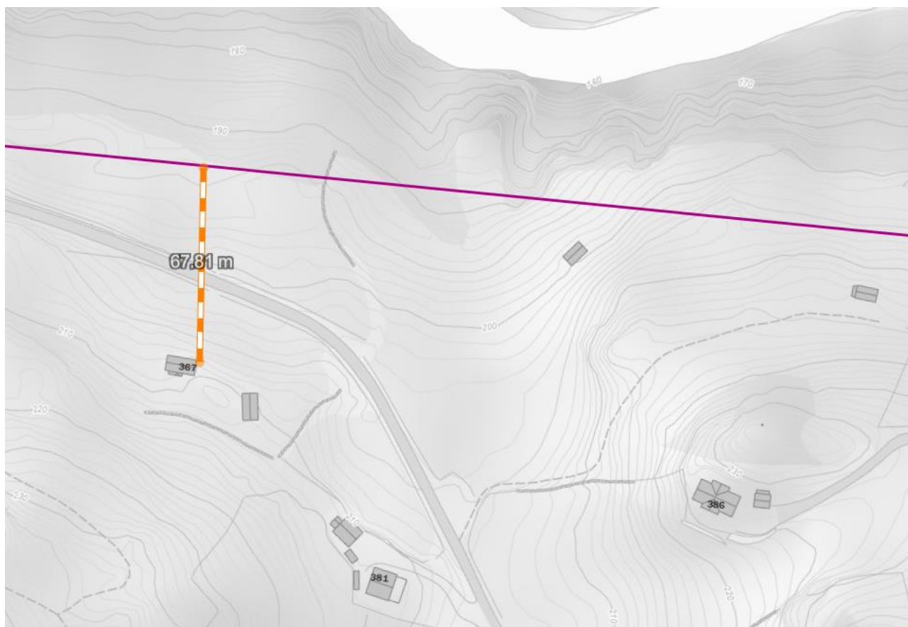
Figur 4-41 Nærmeste bolighus er ca. 68 m fra senter kraftledning, og dermed under utredningsgrensen på 0,4 \mu T.
