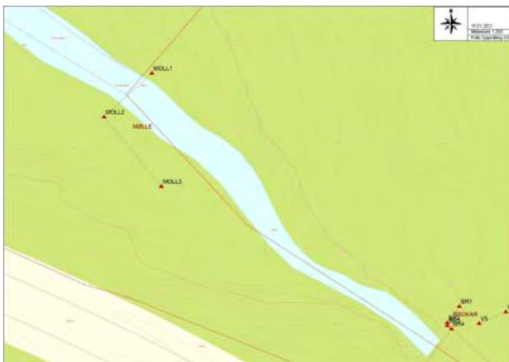
Figur 14 Innmålte punkter på møllefundamenter. Grunnet vanskelig tilkomst kunne ikke målinger gjøres ute i elven. Punkt Moll2-Moll3 er oppmuring langs elven. Kilde: Follo Oppmåling AS
