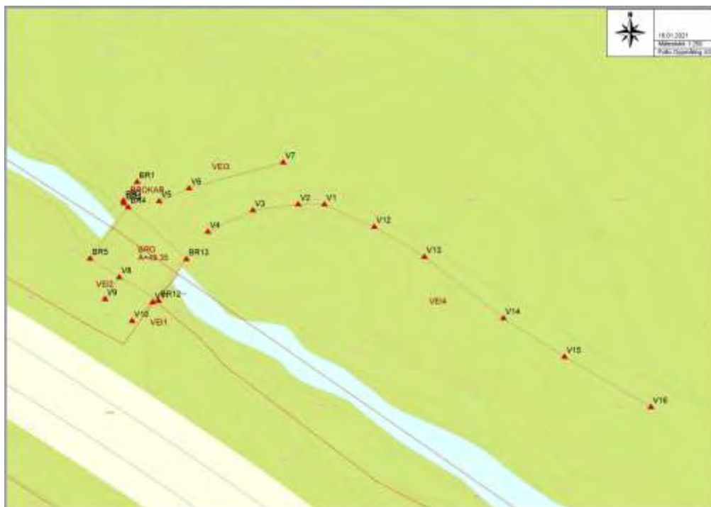
Figur 13 Innmålte punkter på bro, brokar og oppmuringer langs vei. Høydeforskjellen mellom brokar og selve broen er om lag 2 meter. Kilde: Follo Oppmåling AS
