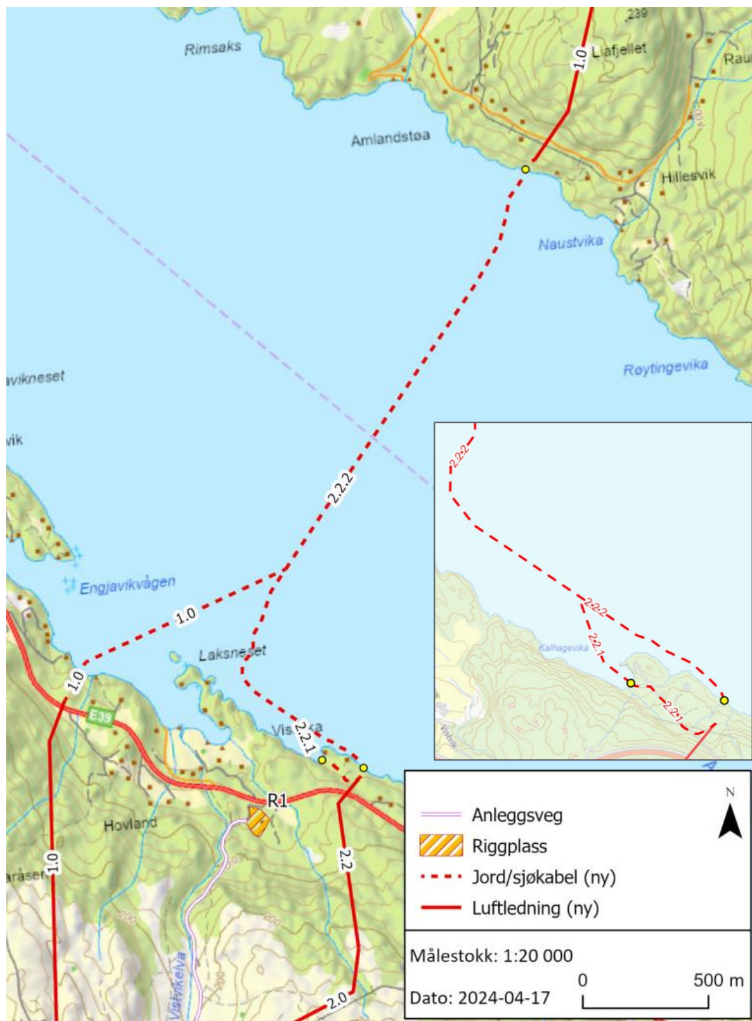
Figur 2-3. Sjøkabeltraseer utredet i denne fagrapporten. Alt. 2.2.1 og 2.2.2 er fullt ut verifisert gjennom feltkartlegging. For alt. 1.0 er det gjort en potensialvurdering, da strekningen ikke er undersøkt i felt.
