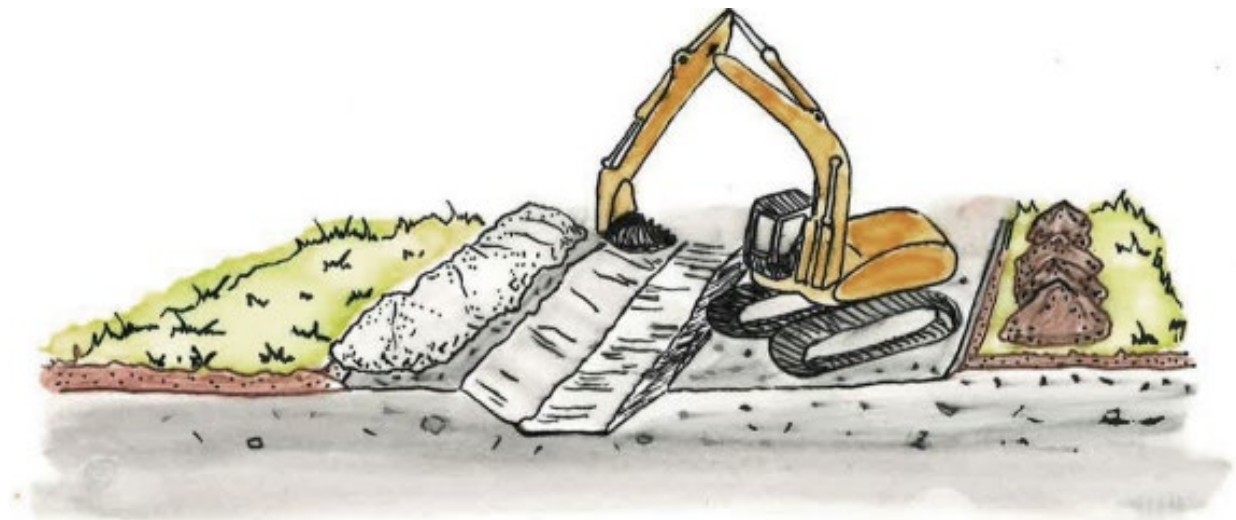
Figur 13, prinsipp for avdekking og mellomlagring av vekstmasser og undergrunnsmasser langs vei og grøft i flatt terreng. Her er massene (vekstmasser og undergrunnsmasser) sortert og lagt på hver sin side av inngrepet. Brune masser til høyre er vekstmasser, mens hvite masser til venstre er undergrunnsmasser.
