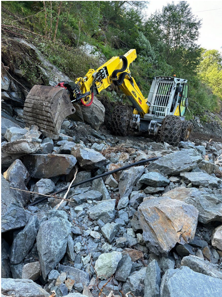
Figur 14, eksempel på bruk av Menzi Muck i bratt terreng
