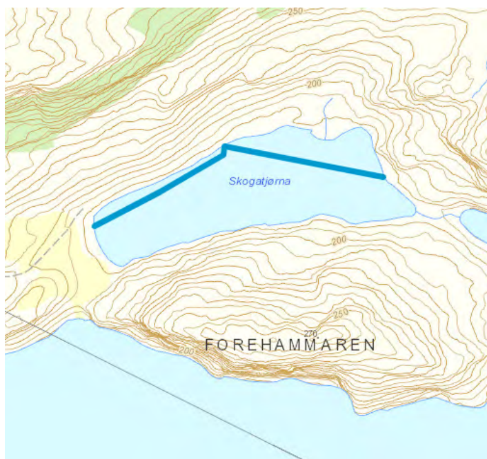
Figur 32: Plassering av siltgardiner under anleggsarbeidene
