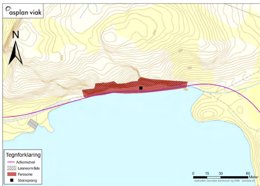
Figur 18: Eksisterende rasområde merket med rødt langs Birkelandsvatnet, skraverte områder er aktuelle løsneområder for ras/steinsprang.
