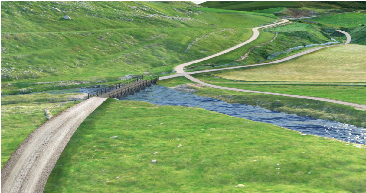
Figur 46: Illustrasjon av plassering av bru over Stølsåna og terrengjustering av bekkeløpet for framtidig flomsituasjon
