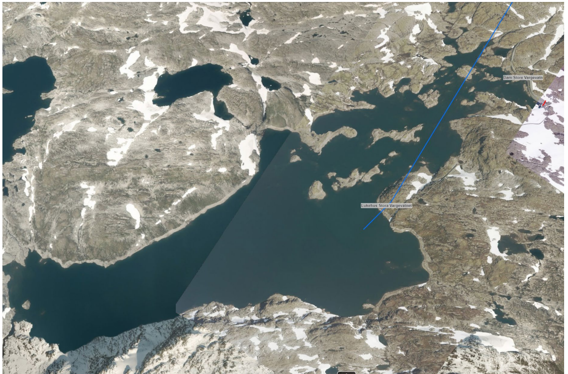
Figur 3 Flybilde av Store Vargevatn. Boblerøret skal legges fra lukehuset og ut i vannet. Blå strek er inntaket/vannveien til Aurland 2 Høye Fall.
