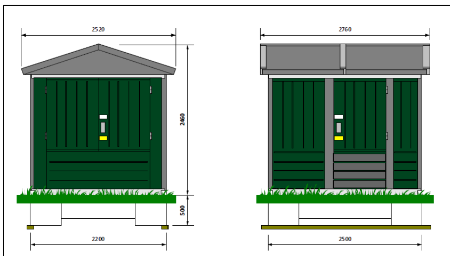
Figur 9 - Eksempelbilde Pre-fabrikkert nettstasjon for Omsøyholman.
