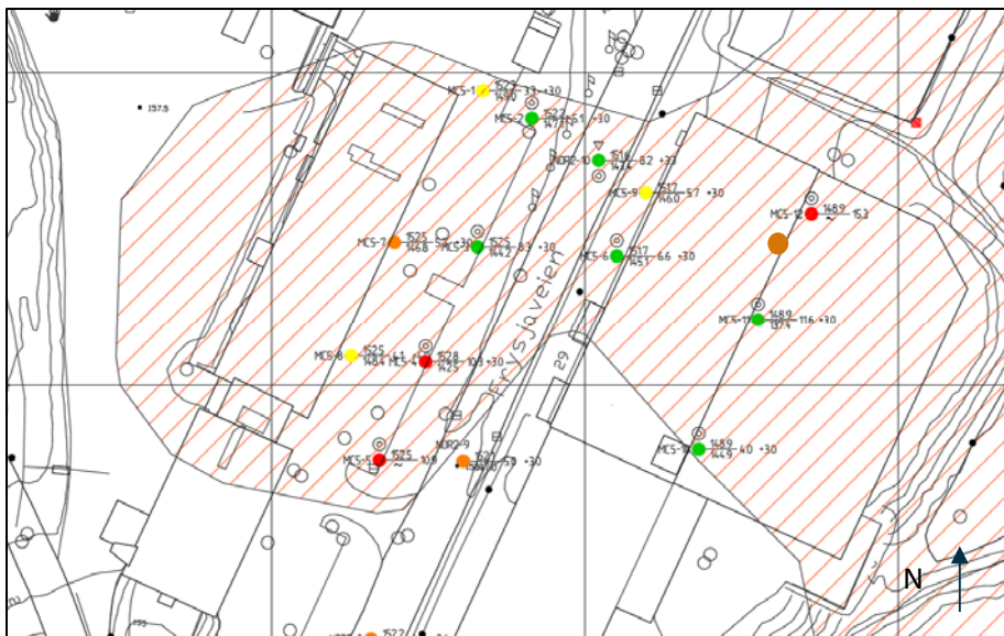
Figur 4-2: Oversiktskart som viser supplerende grunnundersøkelser fra Multiconsult fra 2024 (MC5-XX) samt boringer fra Norconsult fra 2022 (NOR2-XX), ref. [27]. Rød markering – påvist kvikkleire/ sprøbruddmateriale; oransje – antatt kvikkleire/ sprøbruddmateriale; gul – antatt ikke sprøbruddmateriale; grønn – påvist ikke-sprøbruddmateriale.
