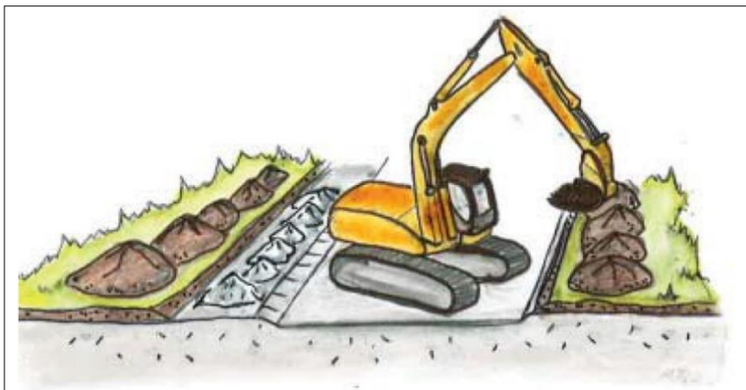
Figur 3-16. Toppmassar skavast av og leggest i rankar på kvar side av arbeidssona. Illustrasjon: Norconsult.
