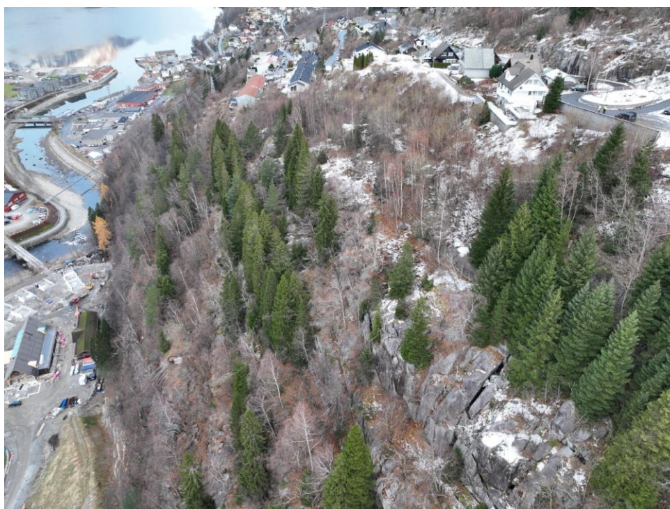
Figur 5-63: Dronefoto over fjellsiden ovenfor Lothepus Camping. Det er observert steinsprangavsetninger på hyllene og avløste blokker i fjellsiden.
