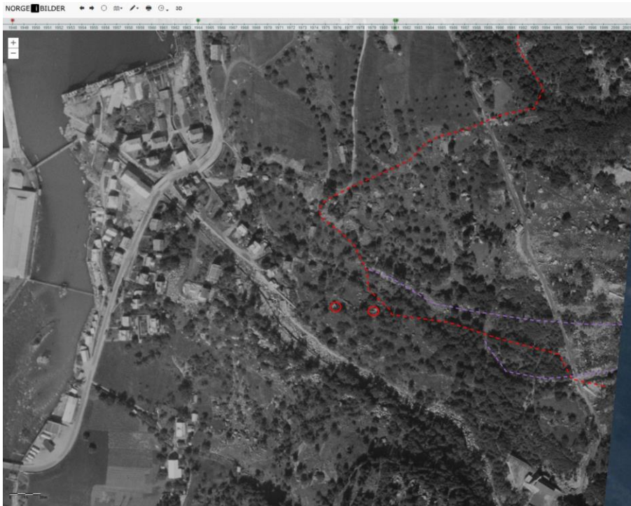
Figur 4-18: Ortofoto fra 1948 som viser tydelige steinsprang og mulig steinskredavsetninger som går langt ned forbi sørsiden av dagens Freim. Lilla stiplede linjer indikerer skredbaner. Antatt større enkeltblokk er markert med rød ring.
