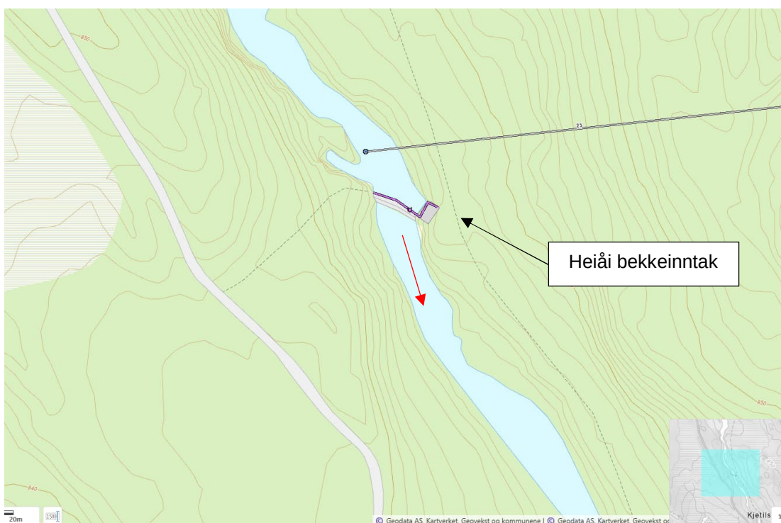
Figur 2 Bekkeinntak Heiåi. Rød pil indikerer hvor minstevannføringen skal slippes.
