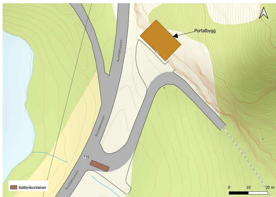
Figur 7: Plassering av batterikontainer ved hovedvei. Alternativet ble forkastet etter geotekniske vurderinger. Kun skisse, ikke faktiske størrelser.
