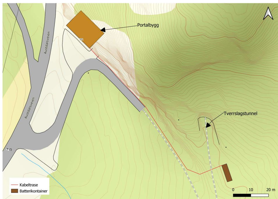
Figur 8: Foreslått plassering av batterikontainer på fundament for kompressorhus utenfor tverrslagstunnel. Kun skisse, ikke faktiske størrelser. Kun skisse, ikke faktiske størrelser.
