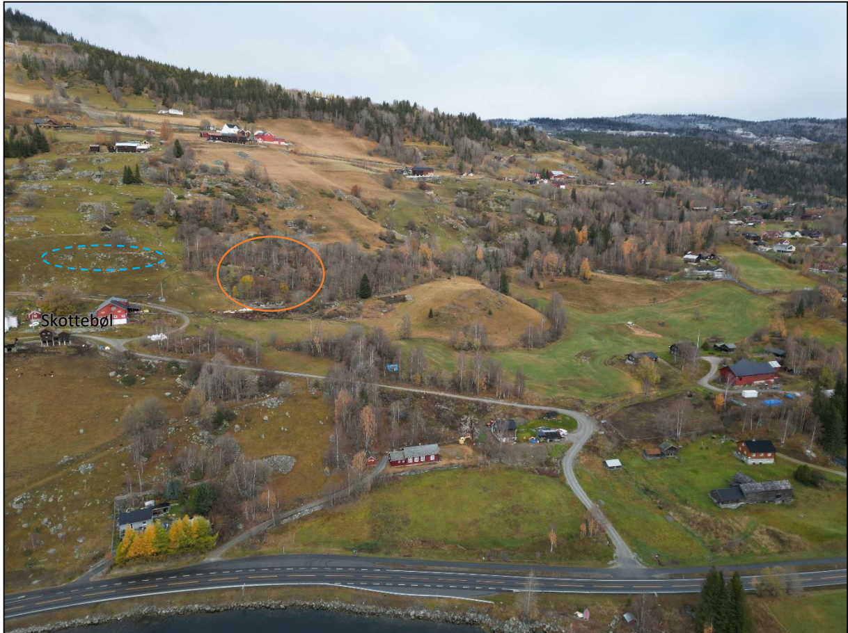
Figur 3: Bildet viser omtrentlig løsnemråde for snøskredet ved Skottebøl (ID18) med blått stiptet omriss. Ellers viser bildet mange av de små bergskrentene, og bratte skråninger, og området med faresone >1/1000 er markert med oransje sirkel. Bildet er tatt mot nord, med drone på befaring.
