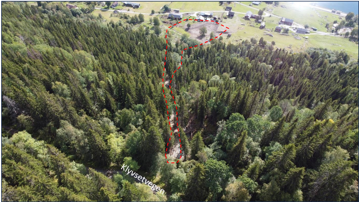
Figur 2: Bildet viser skredløpet sett ovenfra. Klyvsetvegen i nedre del av bildet. Bildet er tatt med drone på beføring ca. 6 uker etter skredet gikk. Vollene kan ses i nedre del av skredløpet. Bildet er tatt mot sør.
