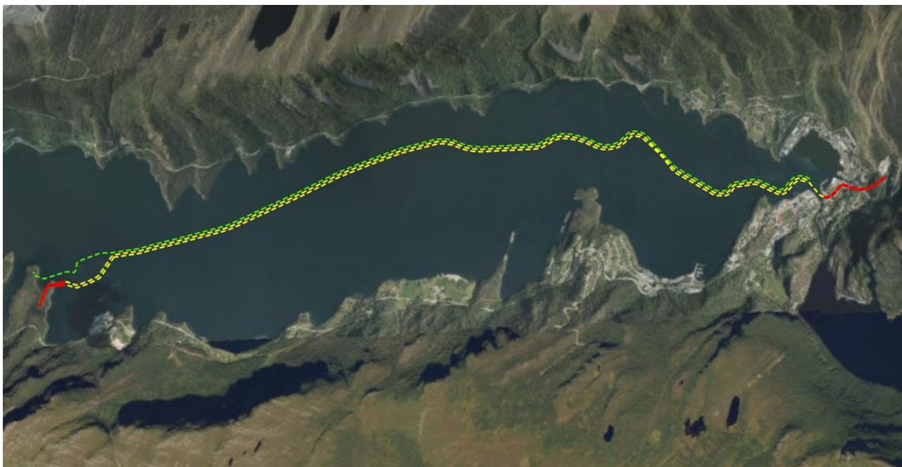
Figur 2-1. Oversiktskartet viser sjøkabeltrasé fra Holmaneset til Svelgen. Sjøkabel er vist med gul stipledd linje (to kabelsett). Parallelt med sjøkabelen legges også ledning for vanntilførsel til produksjonsanlegget på Holmaneset (grønn stipledd linje). Jordkabler er vist med rød stipledd linje.
