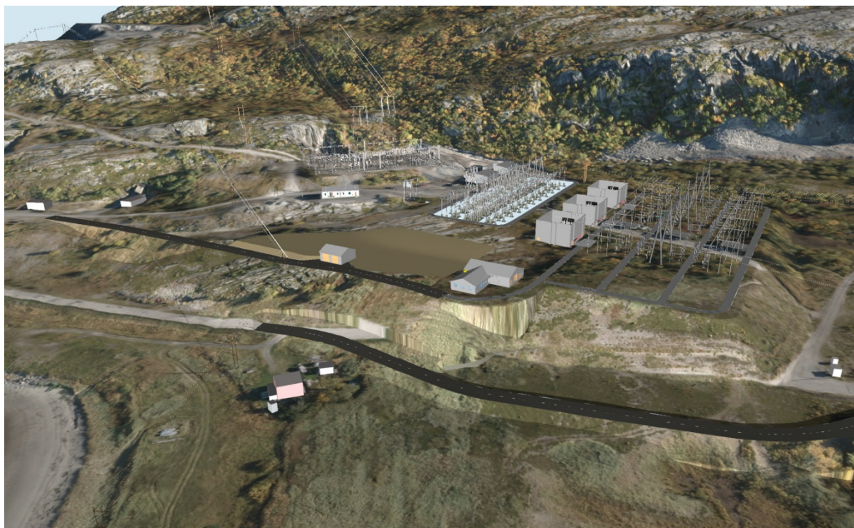
Figur 49: 3D visualisering av Lebesby C. Nytt 420 kV og 132 kV anlegg plasseres på sørvestsiden i forhold til eksisterende stasjon i Adamselv. I 3D bildet ses disse i forgrunnen.
