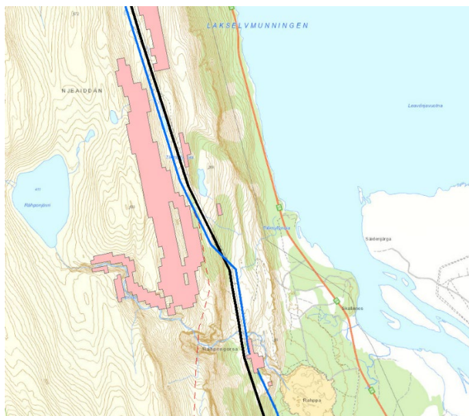
Figur 57: Kartfestet sone for utløsning av skred nord for Lakselv. Data fra NGU (2013).
