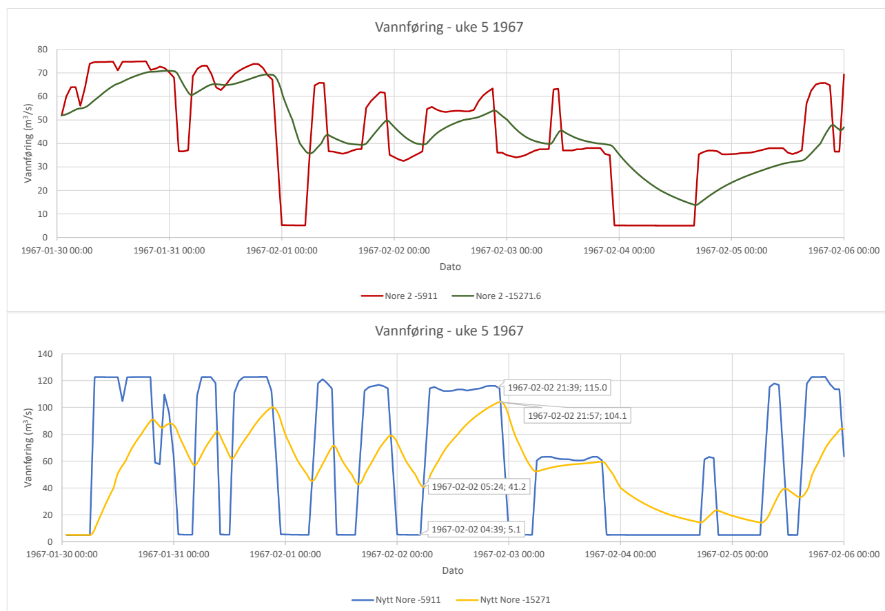
Figur 4-4 Vannføring inn og ut av Norefjorden for simulering av produksjonsvannføring i uke 5 i 1967, scenario A0 øverst (Nore 2) og scenario C1 nederst (Nytt Nore)
