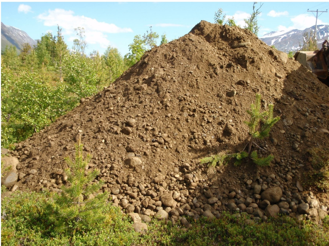
Bilde 6 PG.36. Gravemassene ved stopp graving (ved D=4,6m)
