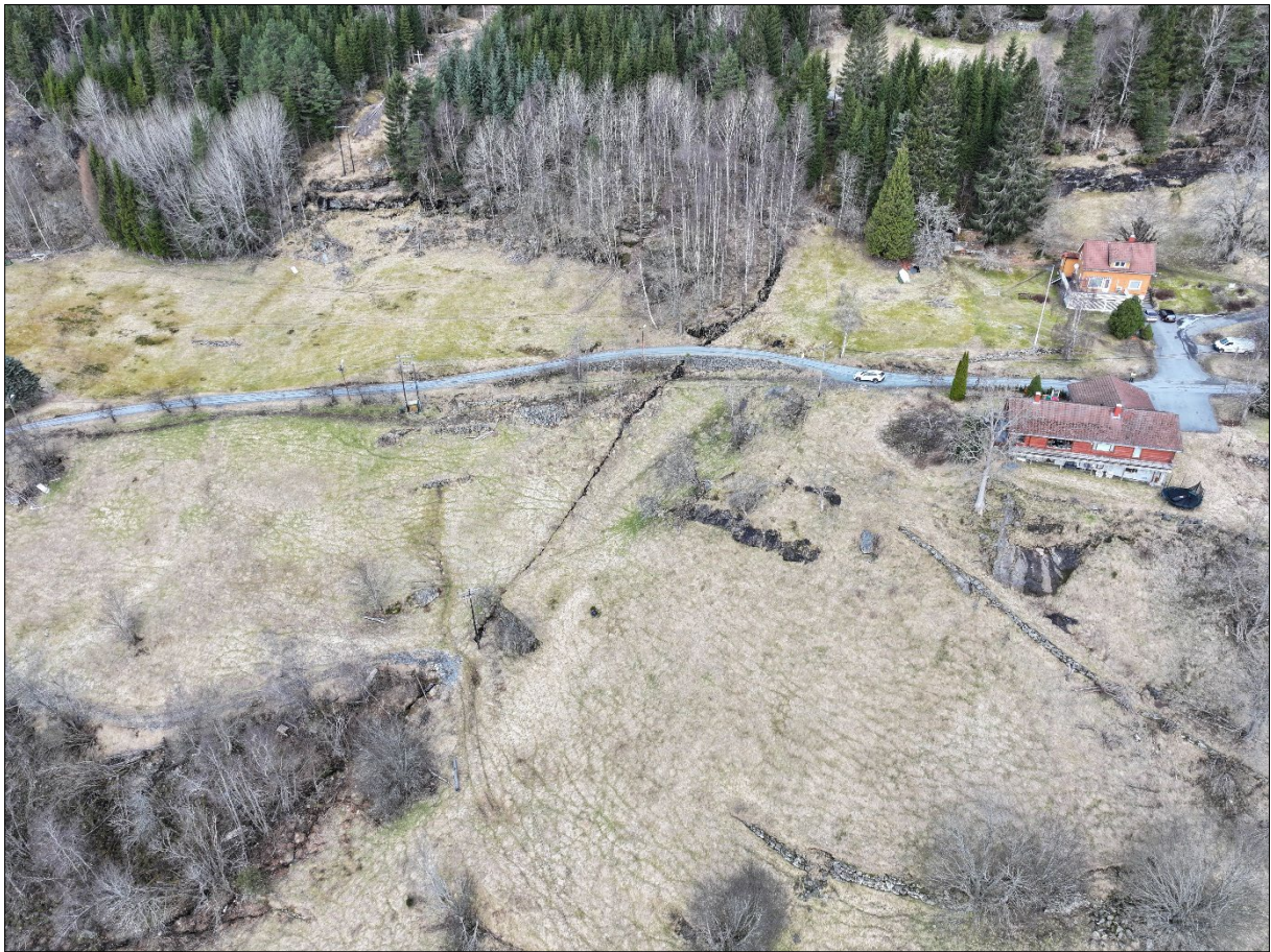
Figur 22: Dronebilde som viser dreneringsvei gjennom midtre deler av påvirkningsområdet. Bekke-/elveløpet renner på bart fjell og i tynne løsmasser (<20 cm). Infopunkt 2.
