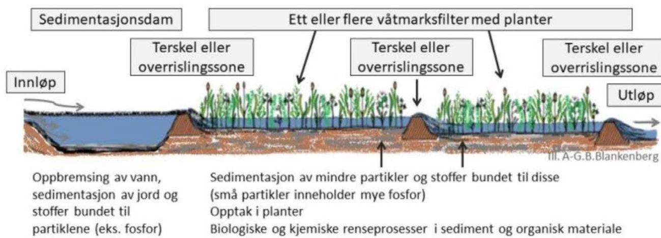
Figur 8 Prinsippskisse av fangdam med sedimentasjonskamre, våtmarksfilter og overrislingssone.
