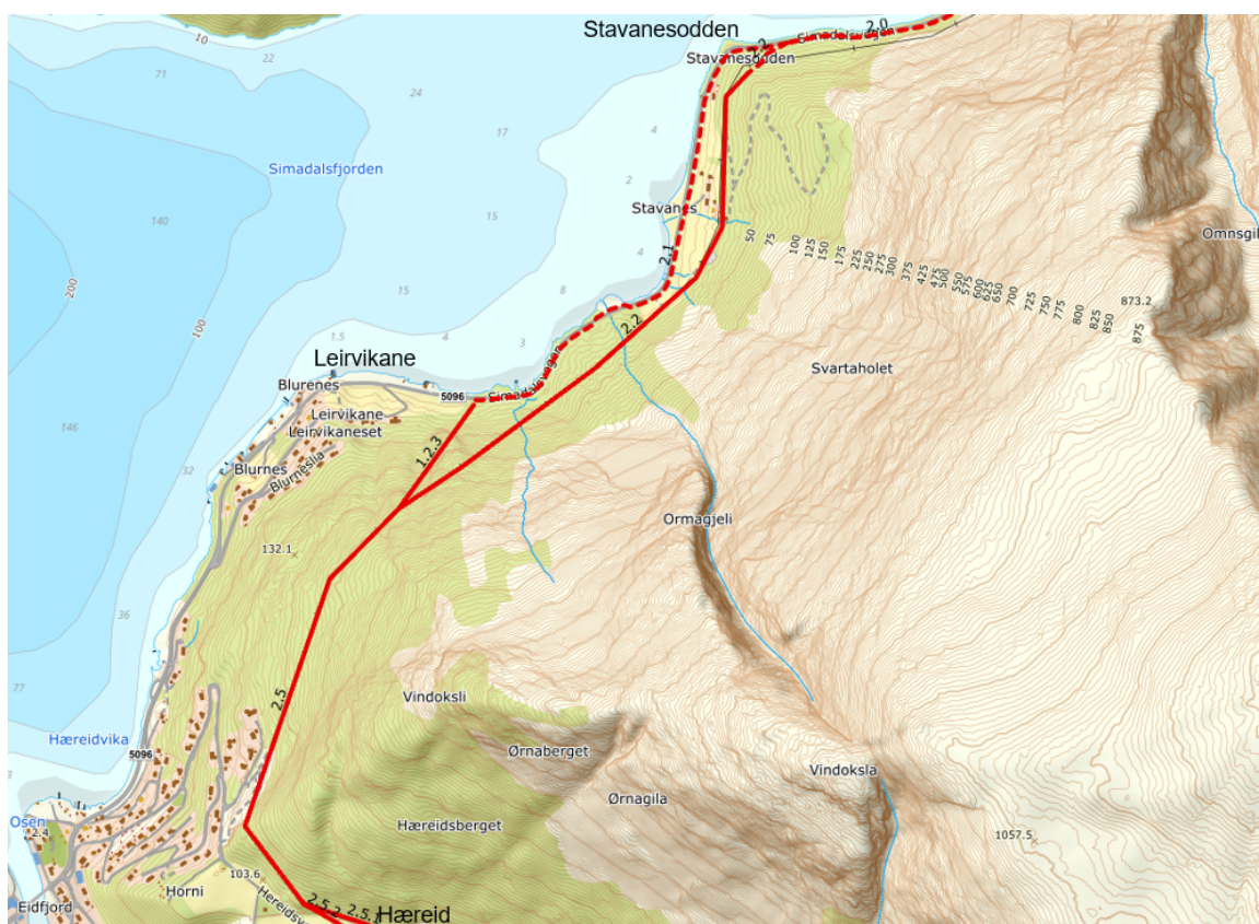
Figur 2-13: Mellom Stavanosodden og Hæreid omsøker IHK to trasealternativ, og prioriterer luftlinje i eksisterende 50 kV trasé (heltrukket rød linje).
