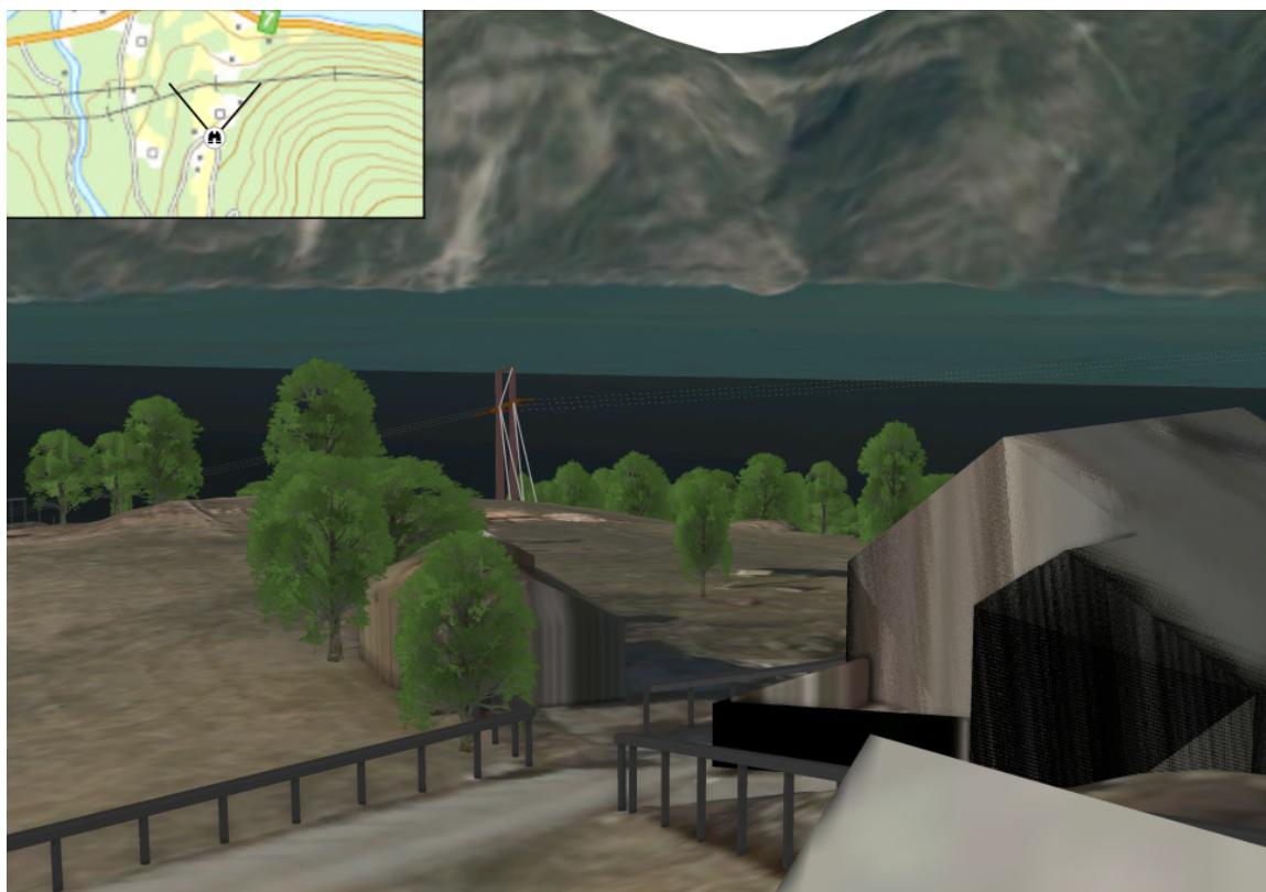
Figur 5-7: Omsøkt 132 kV ledning ved Erdal (M49) sett fra sør mot nord. Prioritert luftalternativ.
