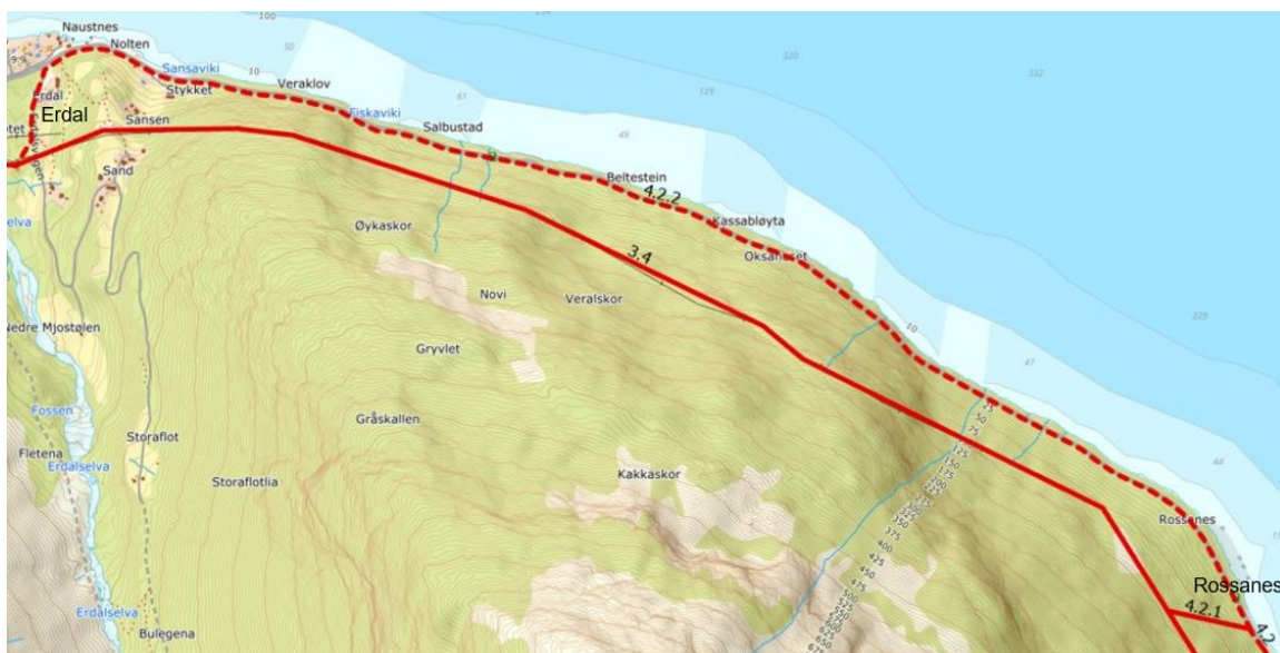
Figur 1-4: IHK omsøker to trasealternativer mellom Rossnes og Erdal, hvor IHK prioriterer luftledning i eksisterende 50 kV trasé.
