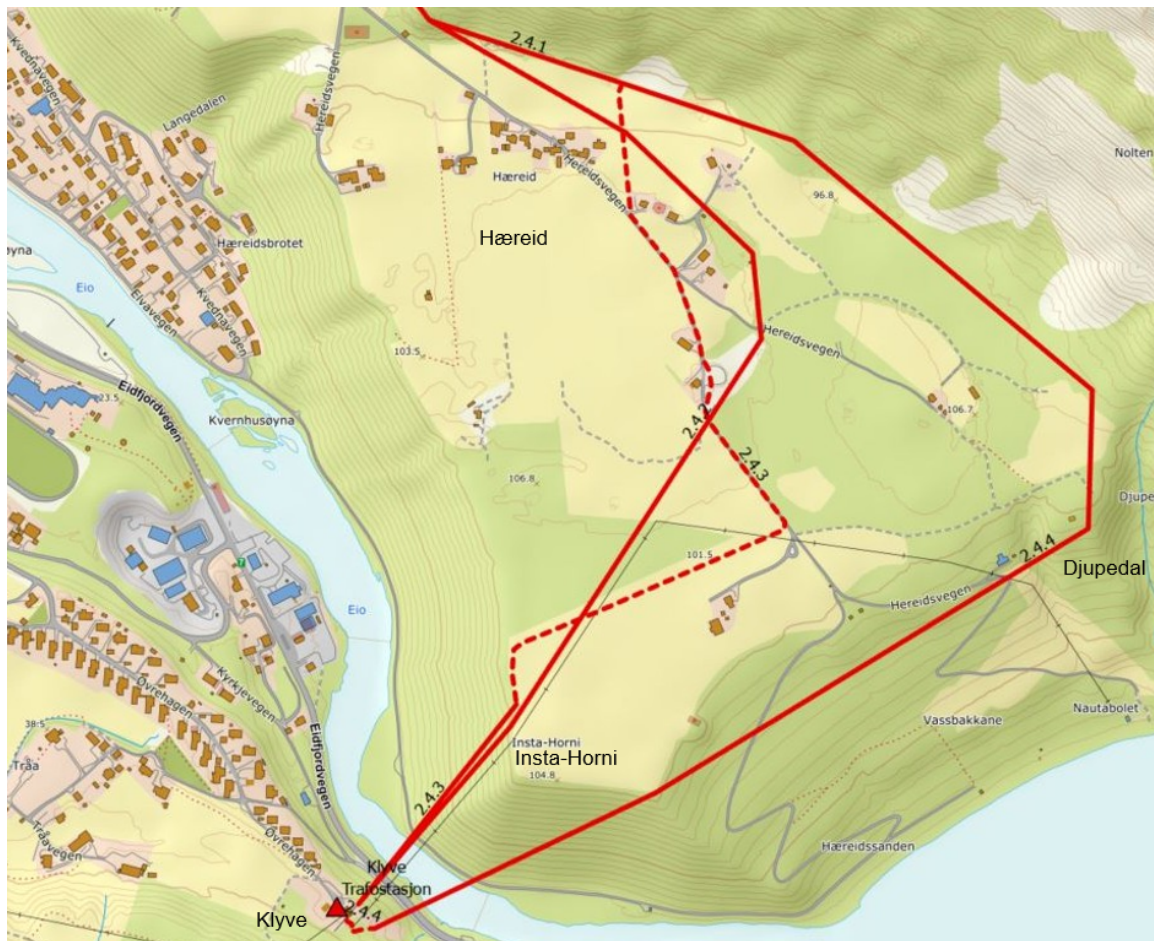
Figur 2-14: Over Hæreid-platået omsøker IHK tre ulike trasealternativer, og prioriterer jordkabelalternativet (stiplet rød linje).
