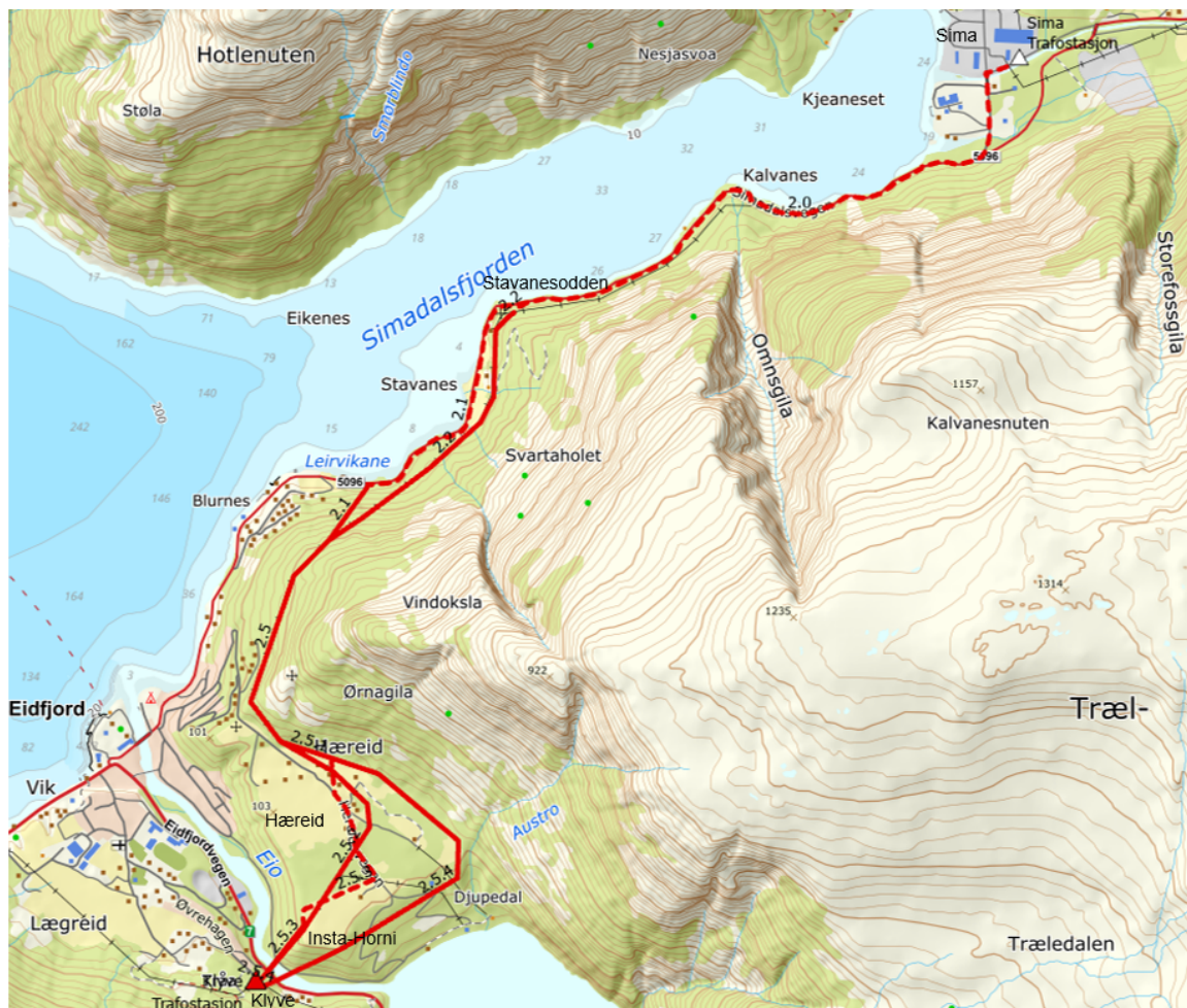
Figur 1-2: Omsøkte trasealternativer mellom Sima og Klyve, hvor IHK prioriterer luftledning fra Stavanesodden til Hæreid og jordkabel over Hæreid-platået.
