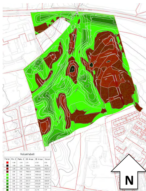
Figur 3-4: Utklipp fra foreløpig volumberegning, datert 14.02.2022. Grønt indikerer oppfylling og rødt indikerer avlasting.
