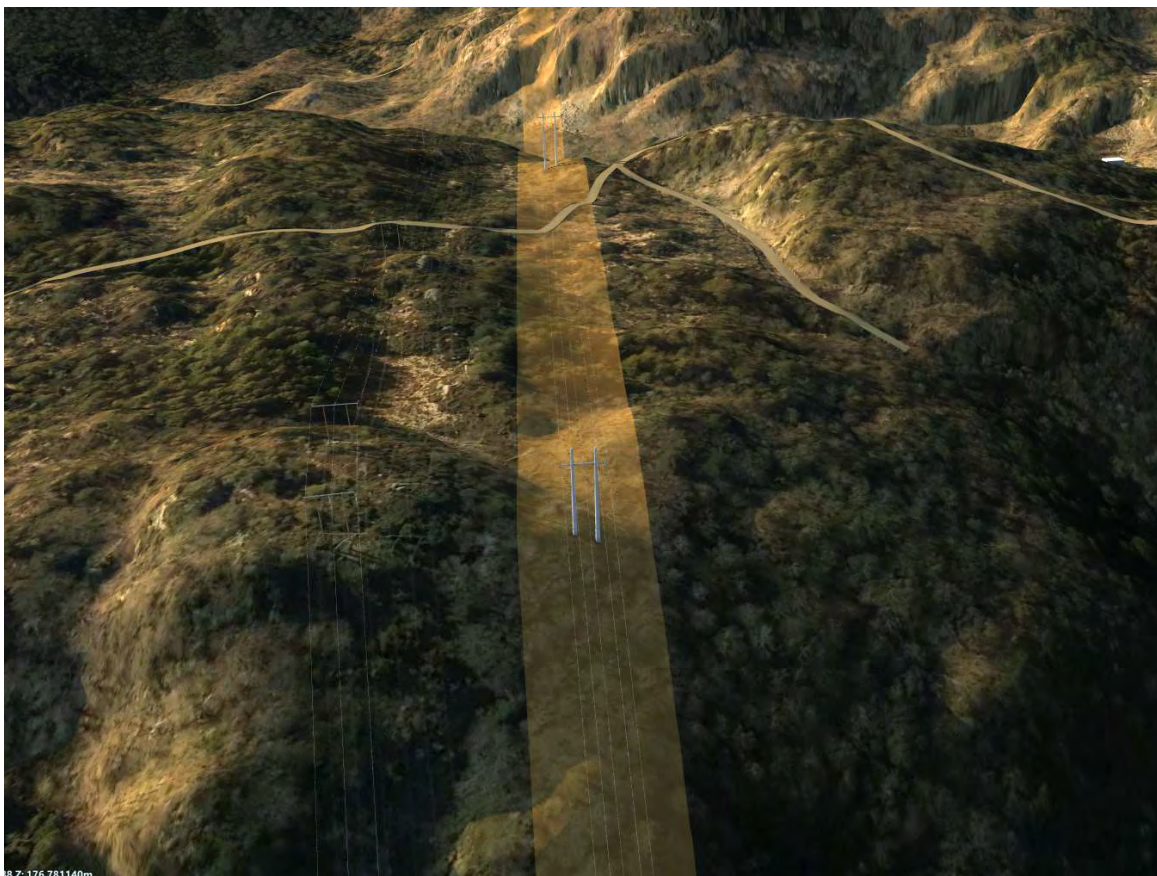
Figur 5-1. Utklipp fra 3D-modell som illustrerer ny ledning (markert med gult belte) med komposittmaster. Mastene er høyere enn dagens master. Eksisterende ledning sees til venstre i bildet (ikke markert med gult belte). Traseen krysser turstier over Flauffell markert med gul linje.
