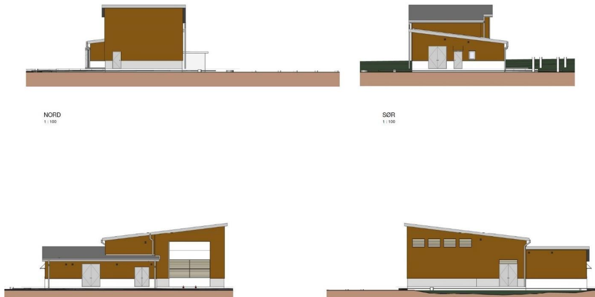
Figur 4-5 Eksempel på utforming av nye transformatorstasjoner i Mehamn og Kjøllefjord med gassisolert koblingsanlegg (GIS). Selve bygget vil beslaglegge et areal på ca. 250 m 2 i Mehamn. I Kjøllefjord vil stasjonsbygget bli noe større, inkludert flere transformatorer enn det som er vist på skissa. Vei- og parkeringsareal etc. kommer i tillegg.
