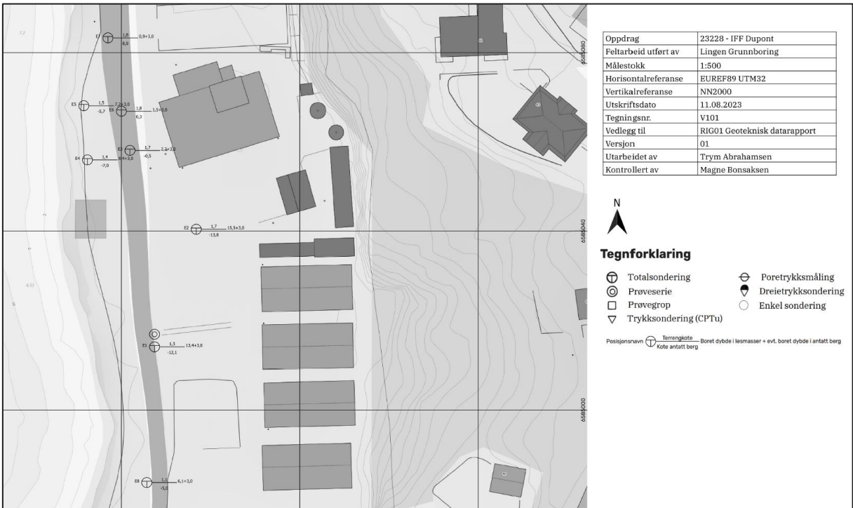
Figur 3-1: Grunnundersøkelser utført av ERA Geo i 2023 ved dagens industriområde. Kilde: 23228A-RIG01 [8]
