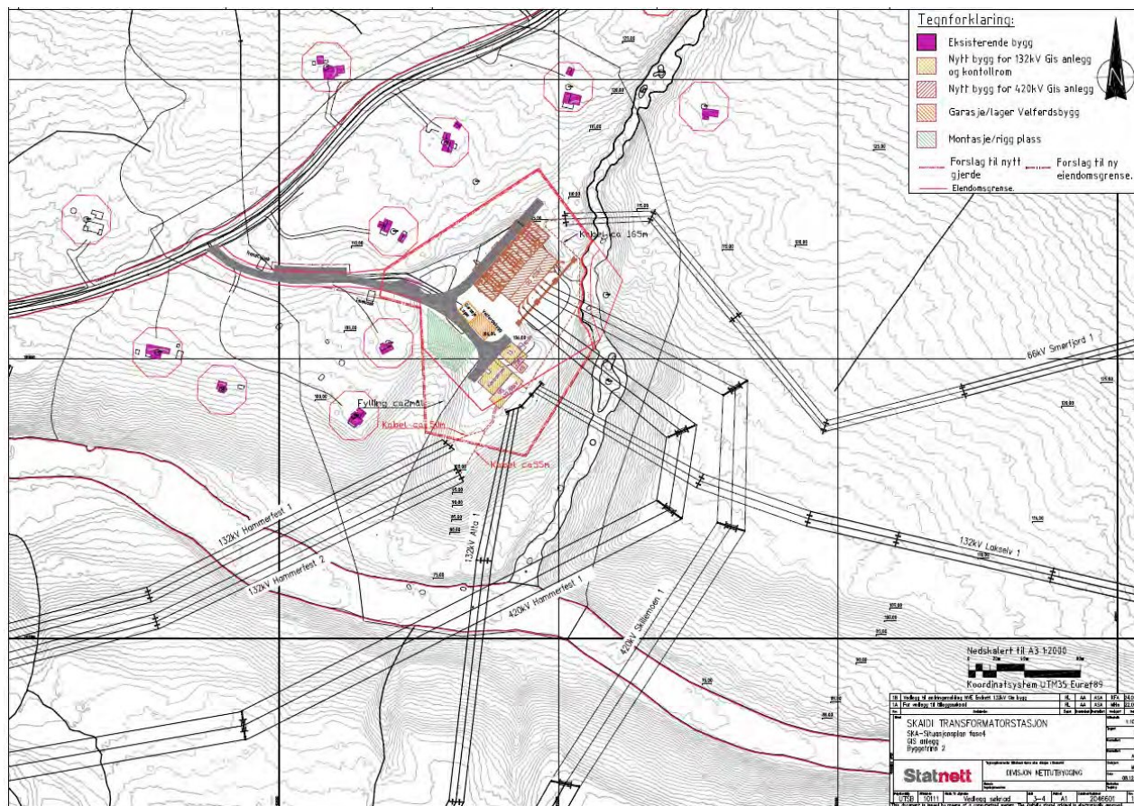
Figur 2-7. Situasjonsplan for Skaidi transformatorstasjon.
