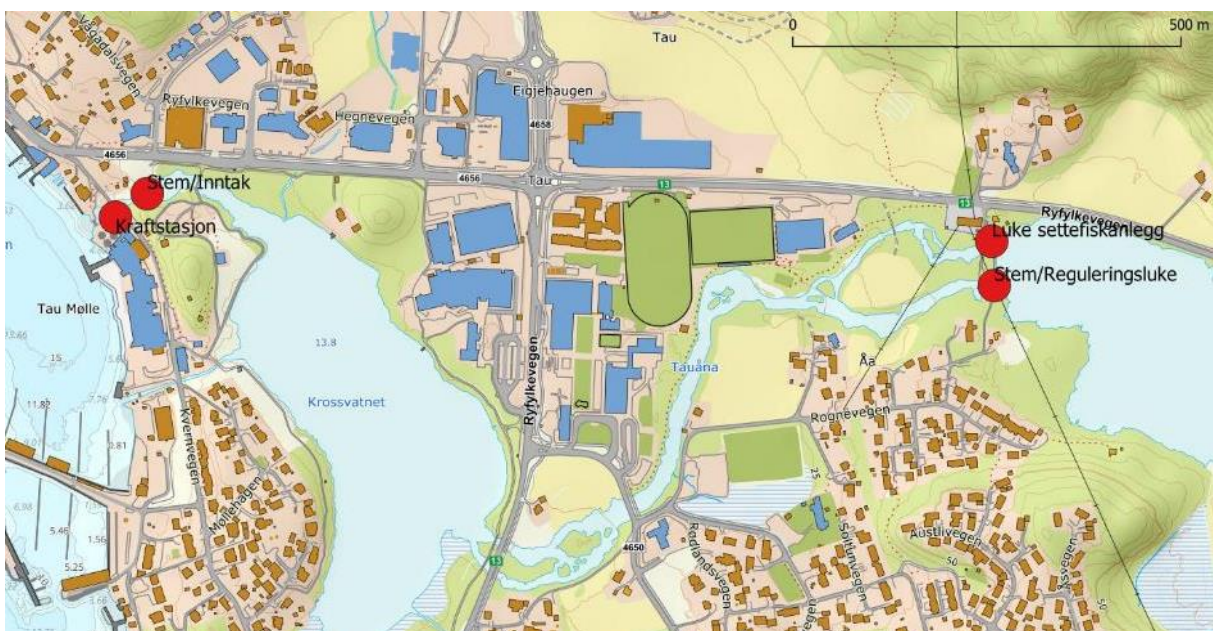
Figur 2.2. Eksisterende kraftverk har inntak på kote 13 i Krossvatnet. Det er reguleringsmulighet ved demning i vestre kant av Bjørheimsvatnet. Når det er drift slippes 10,5 m 3 /s gjennom luka i dammen, og det meste av Tauåna
