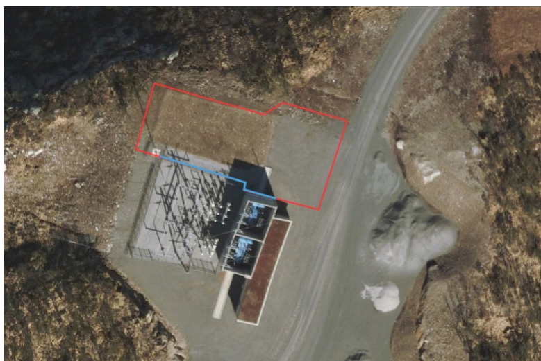
Figur 15. Ytre perimeter inngjerding for batterianlegget.
