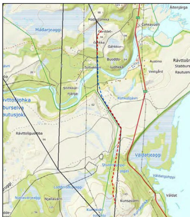
Figur 6-5. Stiplede linjer angir trasé for jordkabel (rød) og tunnel (blå) gjennom søndre del av Stabbursdalen.
