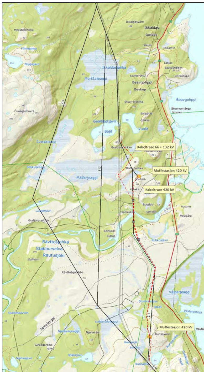
Figur 2-12. Alternative løsninger for kryssing av Stabbursdalen. Rød, stiplet linje angir mulige jordkabeltrasèer.
