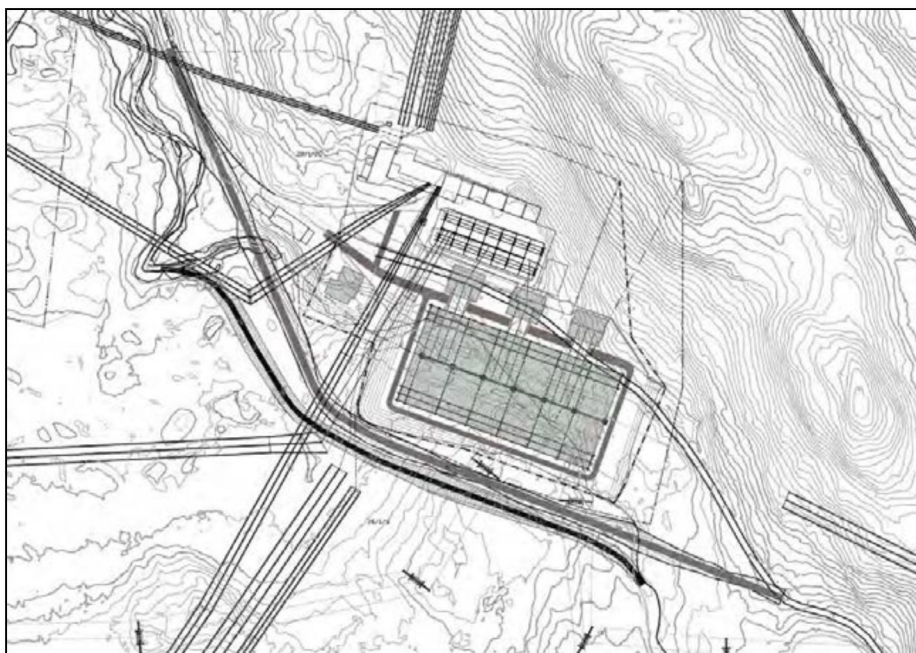
Figur 2-8. Skissen viser eksisterende Lakselv transformatorstasjon sammen med en mulig utvidelse mot sør som 420 kV stasjon (Lakselv, alt. 1).
