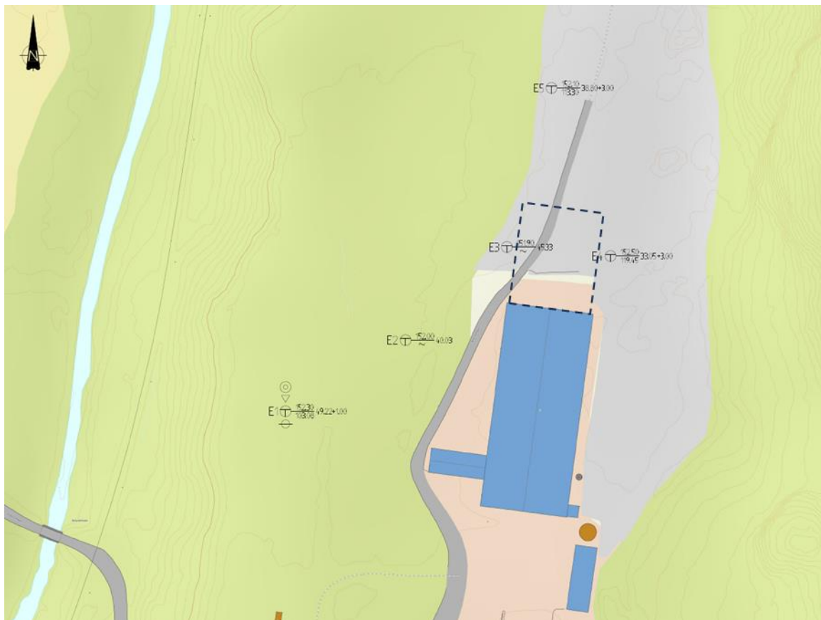
Figur 3: Utklipp fra borplan. Plassering av tilbygg er skissert med stiptet linje. Borpunktene ble justert slik pga. tett skog lenger nordvest.
