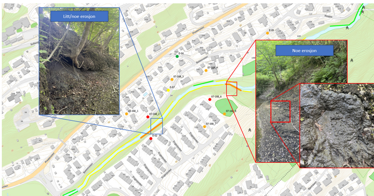
Figur 3: Pågående erosjon i kvikkleiresone Engerjordet I. Bilder er tatt på befaring i 2023.
