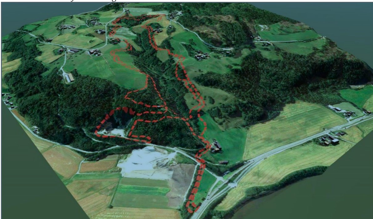
Bilde: område for deponi og plangrense for vedtatt plan. Deponigrense er den indre, stiplede linjen. Illustrasjonen viser området fra nord.
