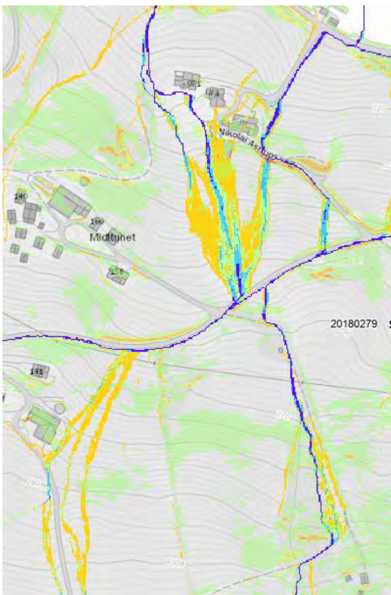
Figur 2-1 Beregnede stier for vannkonsentrasjon ved overflateavrenning brukt for å vurdere hvor vann kan samles i snødekket og utløse sørpeskred
