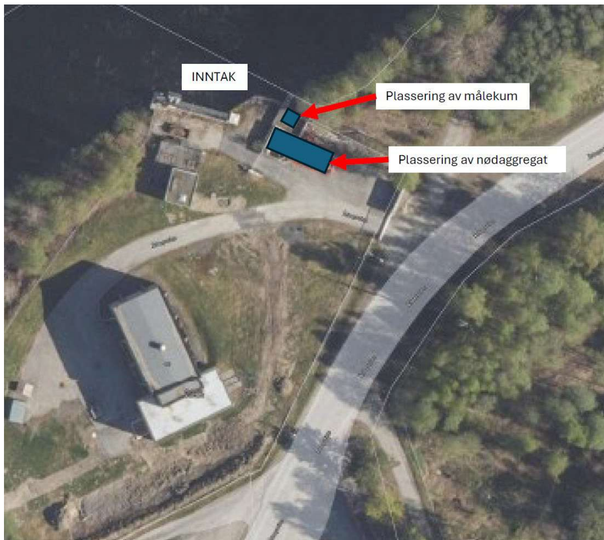
Figur 3 Inntak Hofsfoss – Planlagt plassering av målekum og nødaggregat
