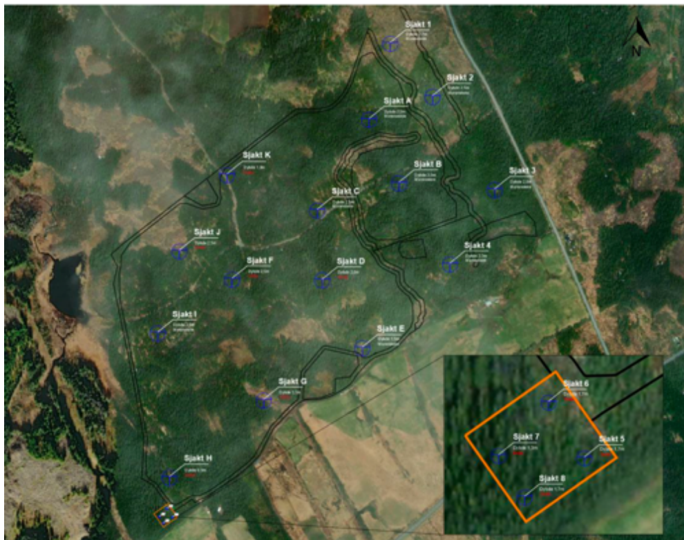
Figur 4-1 Gravesjakter til grunnfjell/fast mark- Kilde VSO Consulting AS
