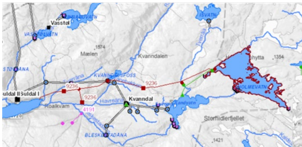
Figur 3. Planlagte nye kraftverk i "østre" del av RSK. Enhet 9236 er nytt pumpekraftverk som forbinder Kvanndalsfoss med Holmavatn.
