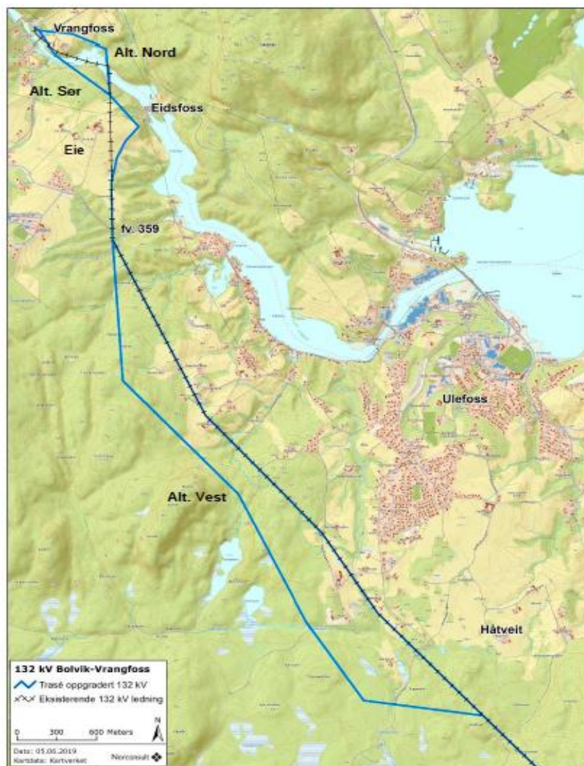
Kart 3: For strekningen mellom Håtveit og fv. 359 er det søkt om to alternativer. Alternativ øst følger eksisterende ledningstrasé. Alternativ vest går i ny trasé.
