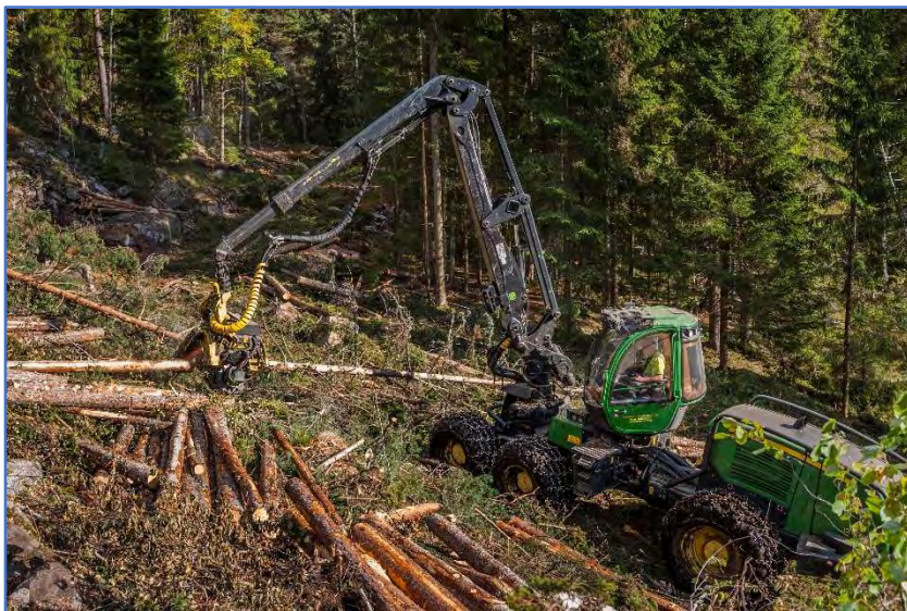
Figur 10-1: Rydding av skog i ledningstraséene gjøres i hovedsak med skogsmaskiner slik skogbruket driver i dag.
