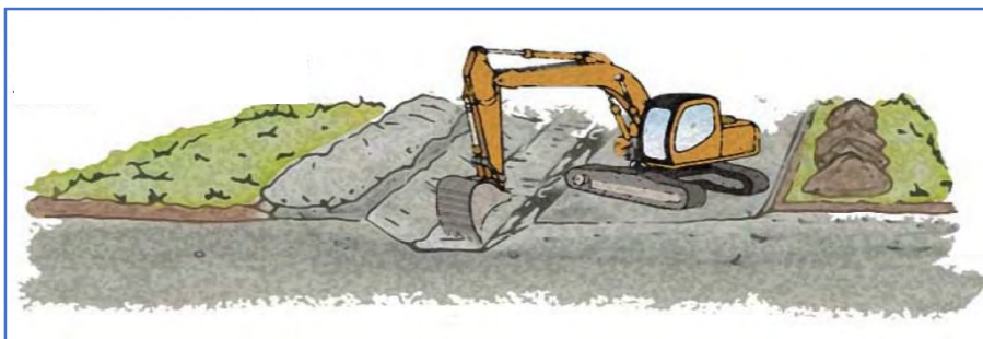
Figur 11-16: Massene som graves ut med gravemaskin legges opp langsmed kabelgrøfta.
