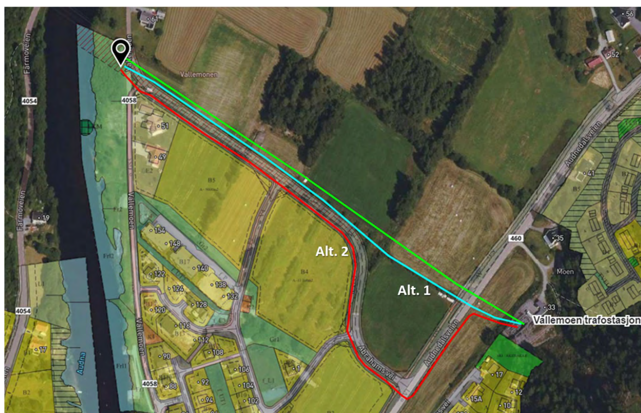
Figur 11-11: Skisse over alternative 132 kV kabeltraséer ut fra Vallemoen transformatorstasjon. Røde og blå linjer er foreslåtte kabeltraséer og grønn linje er dagens 110 kV-ledning.
