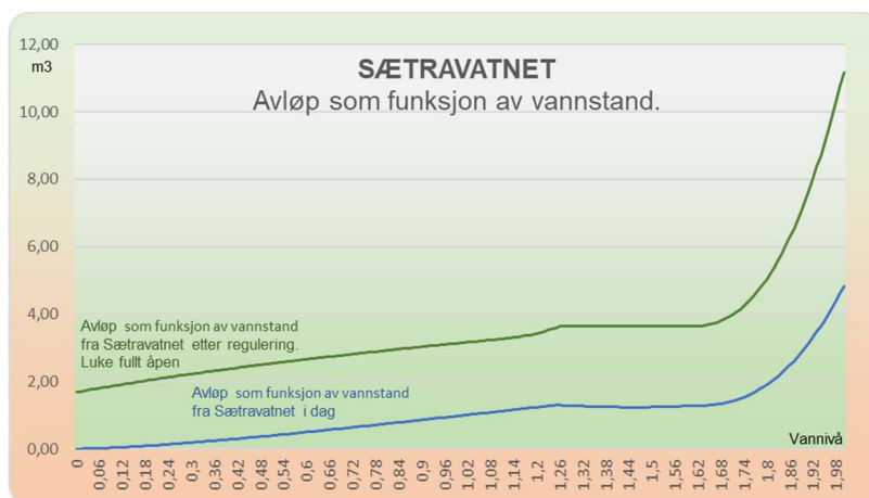
Figur 32 Avløp som funksjon av vannstand
