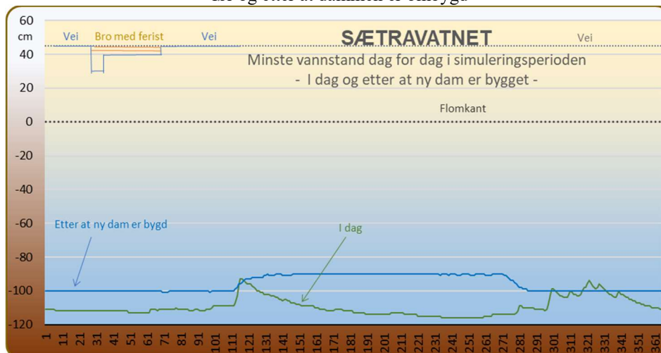
Figur 25. Den daglige maksimal vannstand i Sætravatnet gjennom året - før og etter at dammen er ombygd -
