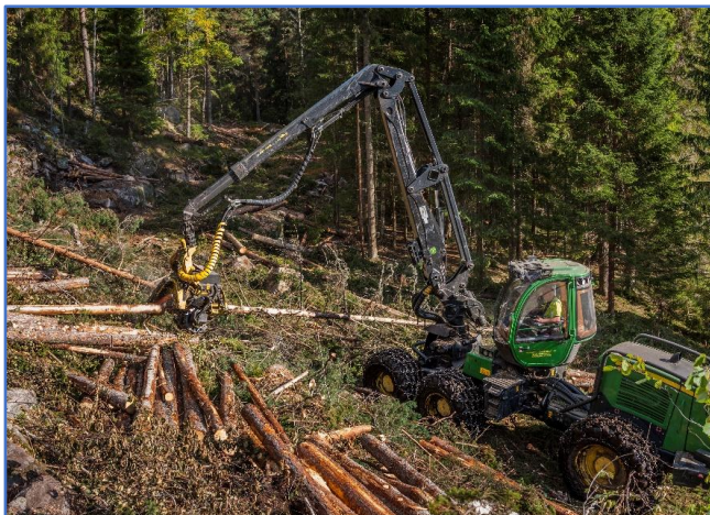
Figur 3-7. Rydding av skog i ledningstraseene gjøres i hovedsak med skogsmaskiner slik skogbruket driver i dag. Eksempel på ryddebelte langs kraftledninger.
