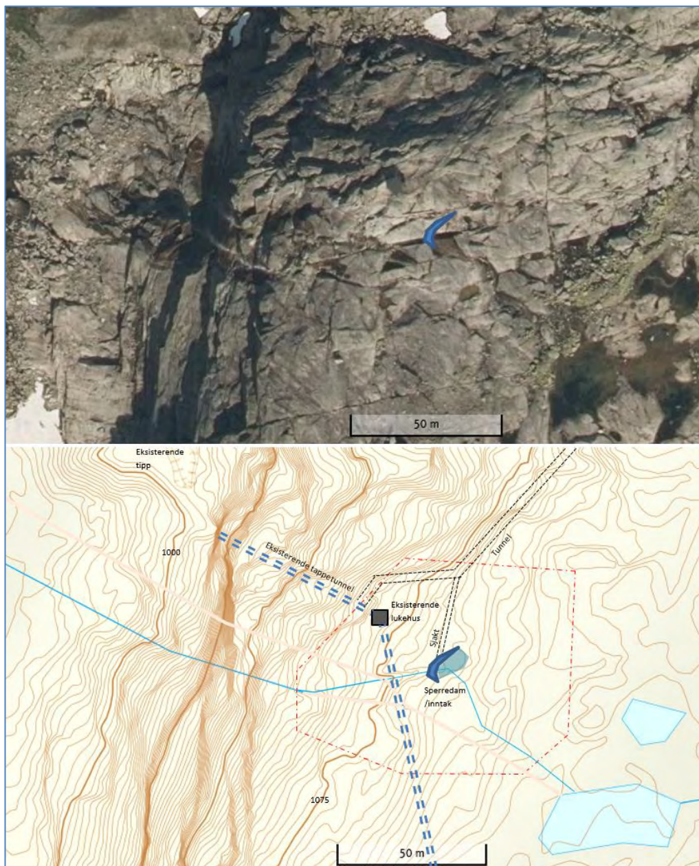
Figur 4-3 Inntak ved lukehus Blådalen, med utstrekning av arealinngrepet angitt
