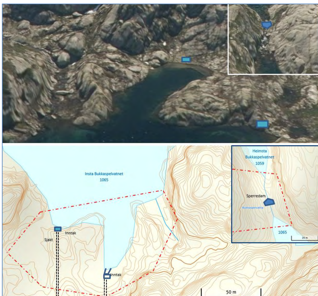
Figur 4-4 Sperredam og inntak i Insta Bukkaspelvatnet, med utstrekning av arealinngrepet angitt
