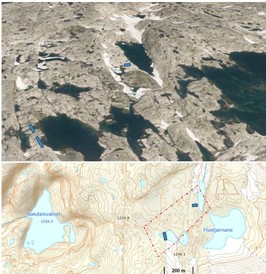
Figur 4-5 Terskler og kanal ved Floetjørnane, med utstrekning av arealinngrepet angitt
